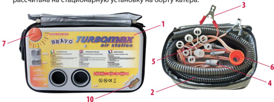
Насос состоит из корпуса (1), воздушного шланга (2), кабеля питания с зажимами «аллигаторного» типа (3), комплекта переходников для клапанов различных типов (4, 5) и штуцера для присоединения воздушного шланга к корпусу (6). На корпусе расположены регулятор контроля давления (7), тумблер питания насоса (8), тумблер запуска (9) и гнездо предохранителя (10). Насос укомплектован сумкой для переноски с отделом для размещения шланга и кабеля.
